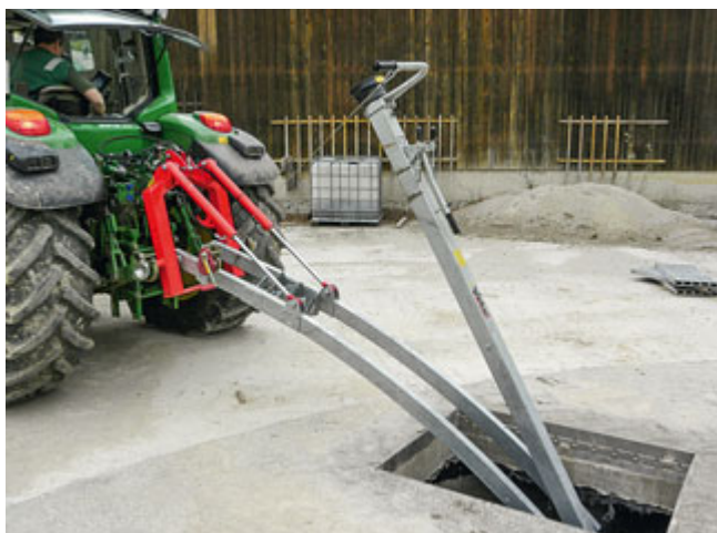
...die Arretierung gelöst. Wenn anschließend per Kurbel und Stahlseil der Mixer verschwenkt ist, kann er durch ein langsames Zurückfahren in die gewünschte Arbeitsposition gebracht werden.
