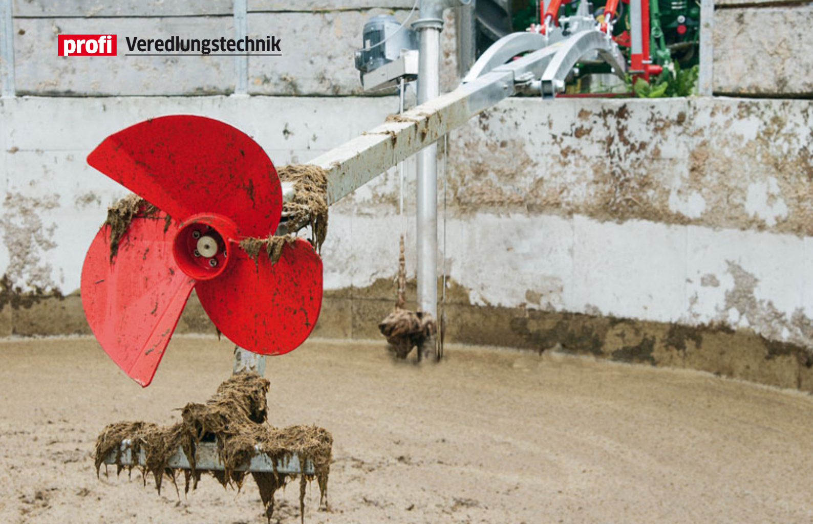
Mit den neuen „High-Effective“-Flügeln von Vakutec wird die Rührzeit verkürzt. Fotos: Schulz, Werkbild (1)
