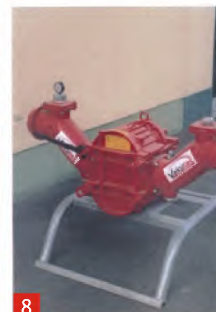
8 Kolben einsetzen, Spannhülse anziehen, Deckel schließen
