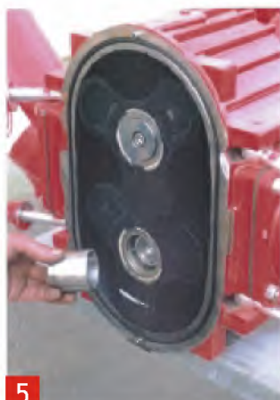
5 Abnehmen der Spannhülsen
