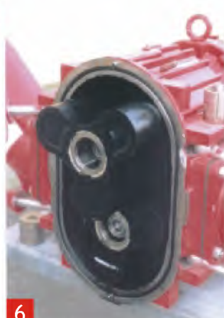
6 Herausnehmen der Kolben
