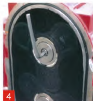
4 Lockern der Befestigungsschraube
