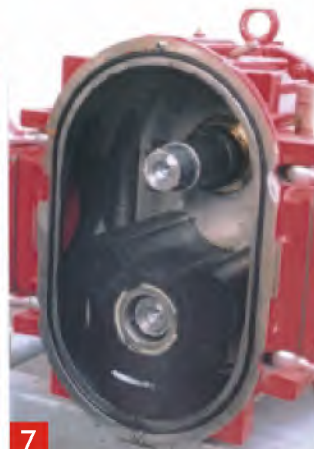
7 Reinigen und Schmieren des Pumpeninnenraumes
