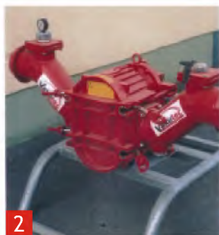
2 Öffnen der 4 Ringmuttern
